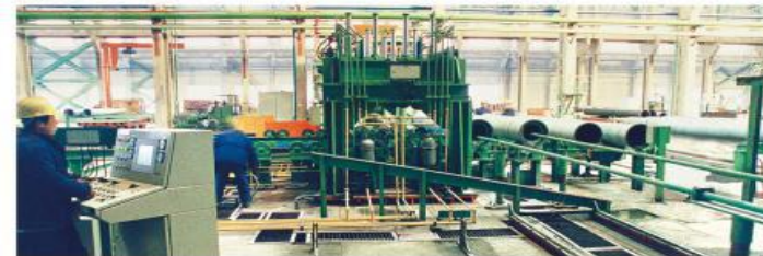
水泥衬层 Cement lining
