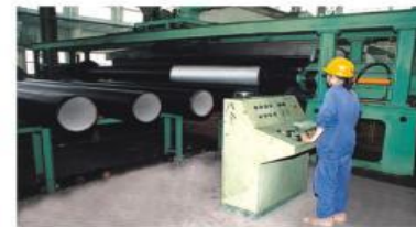
喷沥青 Bitumen coating
