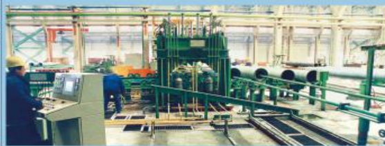
水泥衬层 Cement lining
