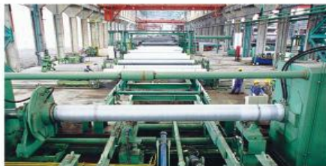
水压试验 Hydraulic pressure test
