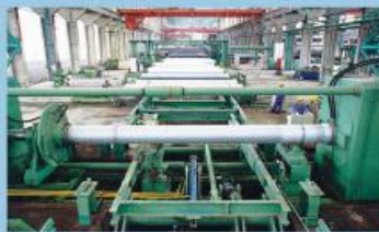
水压试验 Hydraulic pressure testing
